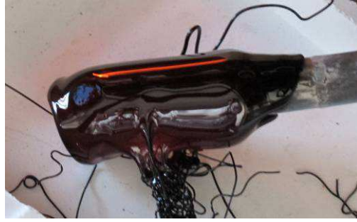
Figure 25 : Verre figé le long du barreau amovible (à l'issue de l'expérimentation de 30 h sur de la fritte de type S).
