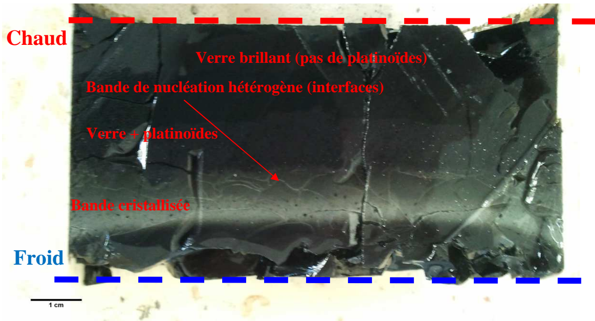
Figure 103 : Section du verre C traité pendant 65 h dans le four à gradient thermique vertical (800 g de verre).
