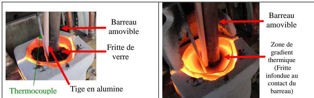
Figure 24 : Four à gradient thermique horizontal. Gauche : avant que la fritte de verre de type S ne soit fondue. Droite : 15 minutes plus tard.
