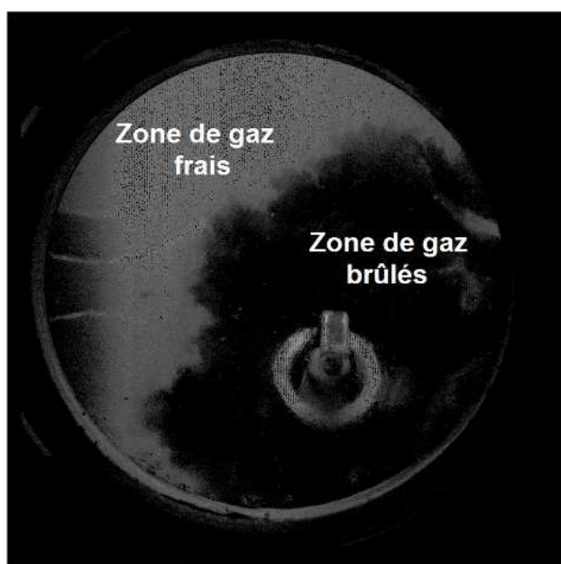
Figure 52 : Visualisation de la combustion par tomographie par diffusion de Mie
