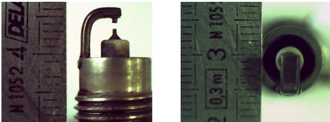
Figure 34 : Caractéristique de la bougie pointe-pointe
