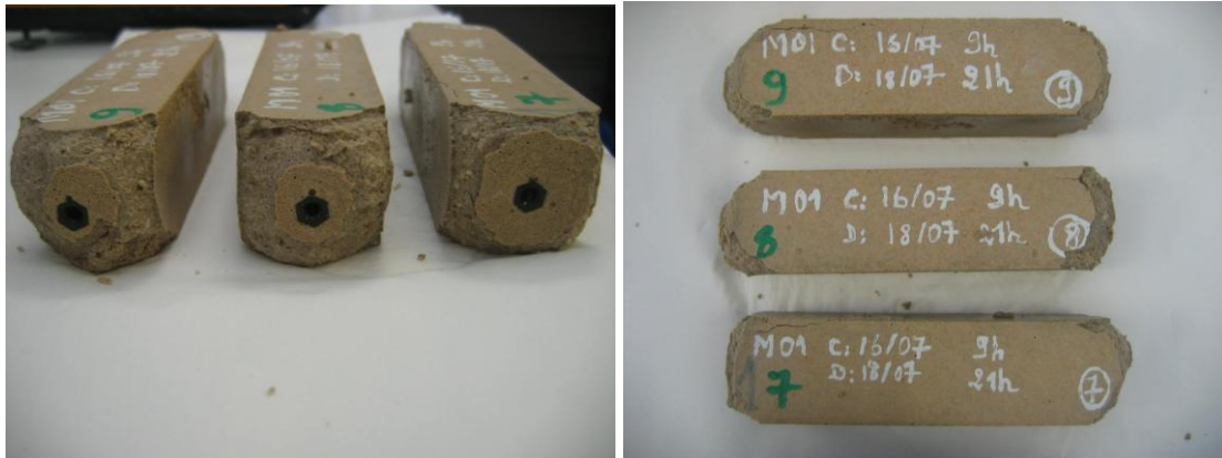
Figure III-54 : Endommagement des mortiers en CEMII/59 au quatrième mois - Immersion complète
