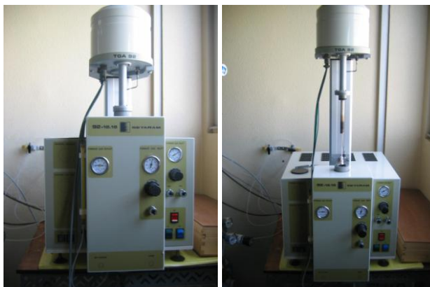
Figure IV-13 : Dispositif utilisé pour l'analyse thermogravimétrique – Université d'Orléans
