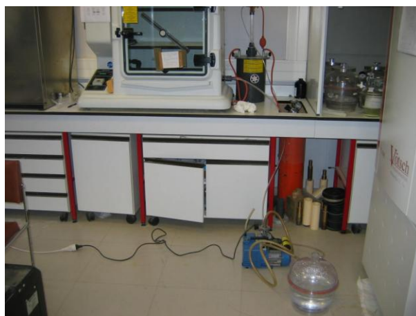
Figure III-17 : Dispositif de purge de l'armoire à condensation du SO 2
