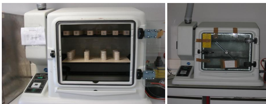
Figure III-16 : Armoire à condensation du SO 2
