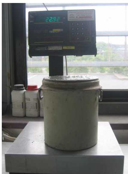
Figure I-12 : Mesure de la masse volumique réelle
