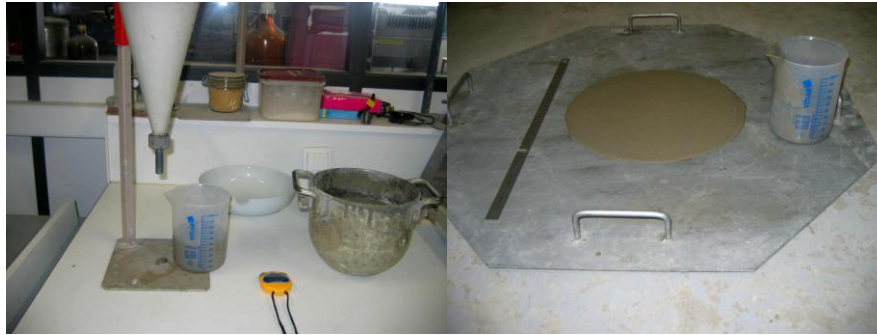
Figure II-18 : Essai de mesure du seuil de cisaillement selon Roussel et Coussot
