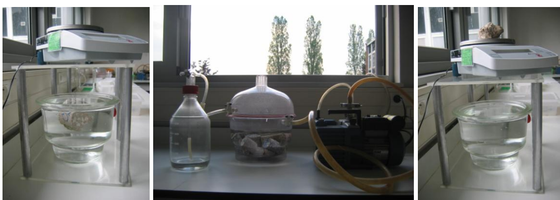
Figure IV-9 : Dispositif utilisé pour la détermination de la porosité totale à l'eau
