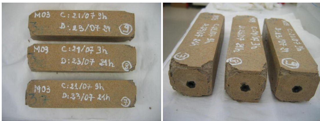
Figure III-55 : Endommagement des mortiers en CEMII/49 au cinquième mois - Immersion complète
