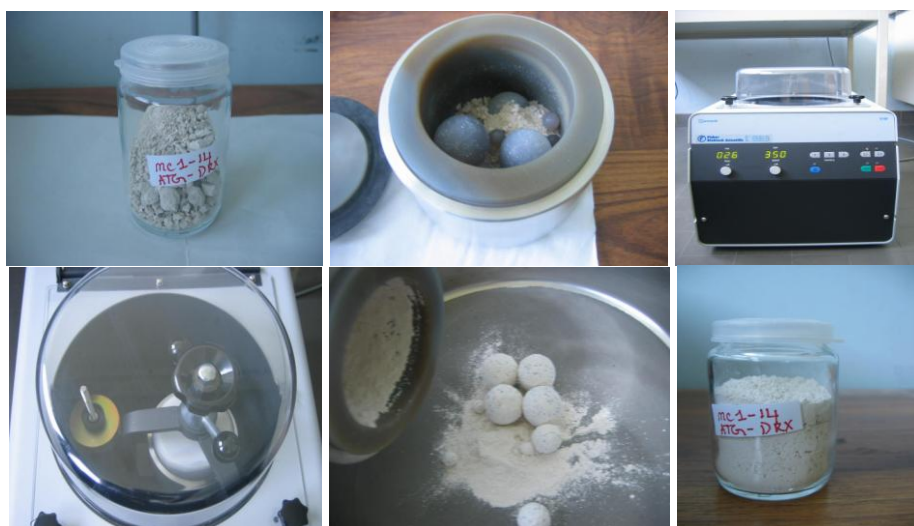
Figure IV-12 : Préparation des échantillons pour l'ATG et la DRX
