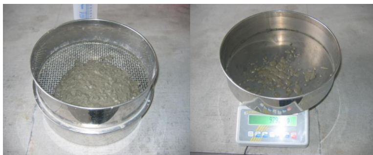
Figure I-8 : Essai de stabilité au tamis
