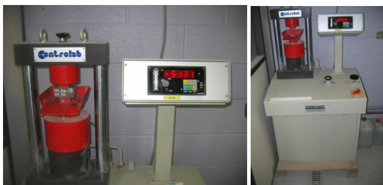
Figure III-4 : Presse des éprouvettes de mortier de l'Ecole Polytechnique d'Orléans
