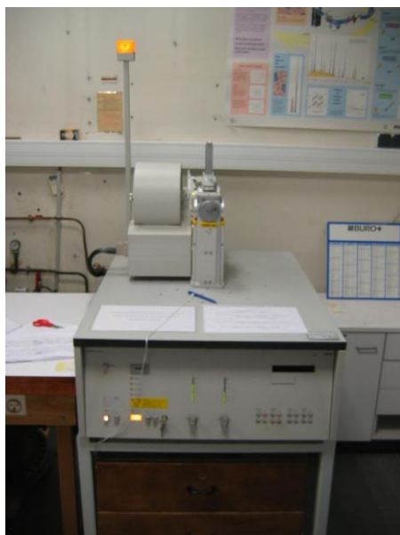
Figure IV-22 : Appareil de caractérisation par diffraction X sur poudre
