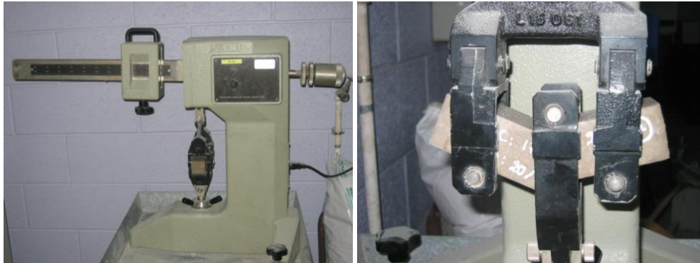
Figure III-5 : Appareil de mesure de la résistance à la flexion des mortiers
