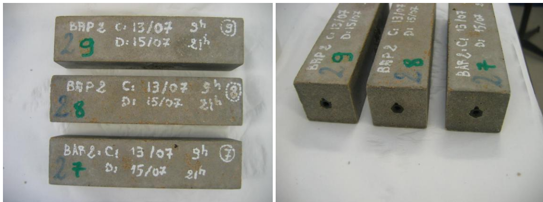
Figure III-59 : Mortiers en CEM I/59 à la fin du protocole Immersion complète
