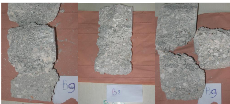
Figure II-17 : Eprouvettes 11x22cm après écrasement à la compression
