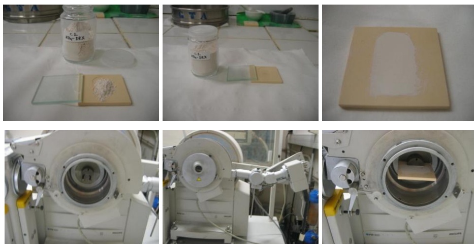
Figure IV-21 : Préparation des échantillons pour la caractérisation à la DRX
