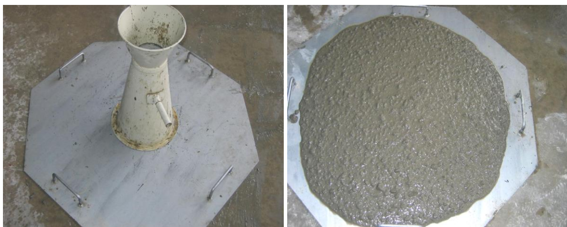
Figure I-2 : Essai d'étalement au cône d'Abrams (slump flow)
