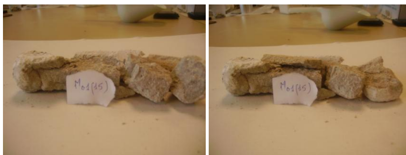
Figure III-29 : Ruine totale des mortiers issus des bétons CEMII/59 - Immersion/séchage à 105°C
