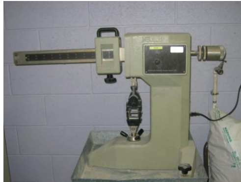
Figure I-14 : Mesure de la résistance à la traction par flexion des 4x4x16 cm
