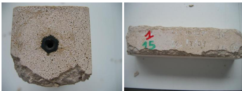
Figure III-28 : Endommagement localisé des mortiers issus des bétons CEMII/59 - Immersion/séchage à 105°C
