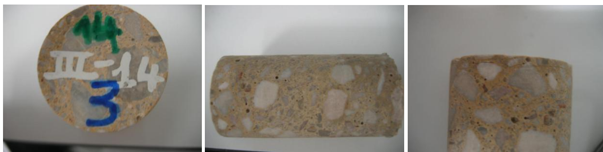
Figure III-51 : Endommagement des mini-cylindres en CEMII/49 - Immersion complète à 3 mois jours
