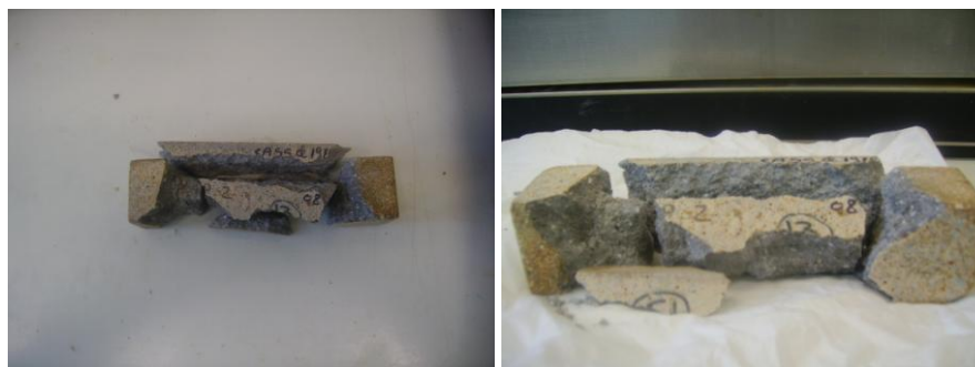
Figure III-30 : Ruine totale des mortiers issus des bétons CEMI/59- Immersion/séchage à 105°C
