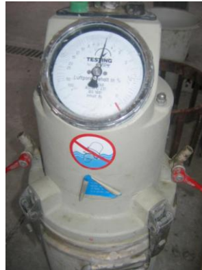
Figure I-10 : Mesure de l'air occlus à l'aide d'un aéromètre
