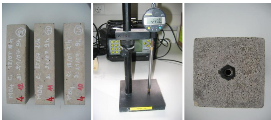
Figure III-20 : Prise hebdomadaire de l'allongement pour les mortiers munis de plots
