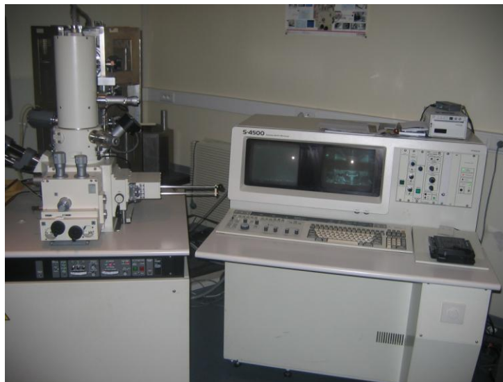
Figure IV-27 : Microscope électronique à balayage de l'université d'Orléans
