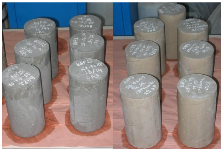
Figure I-11 : Parement d'un béton autoplaçant
