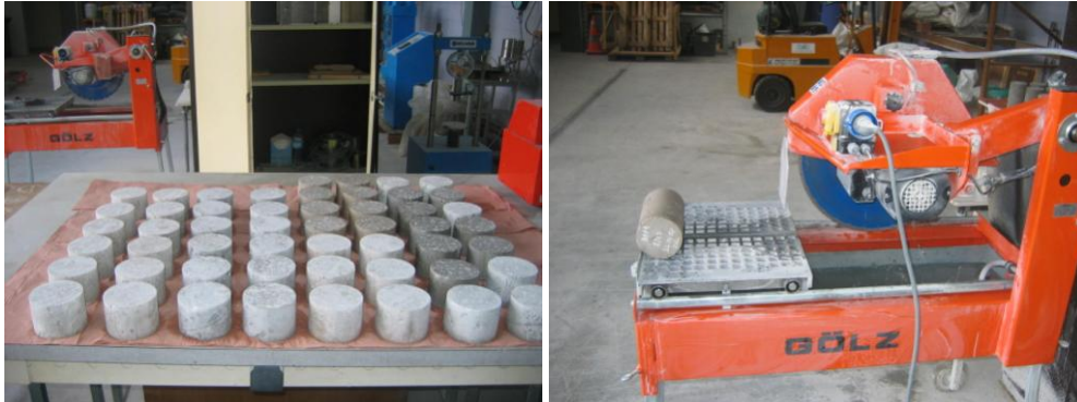
Figure III-9 : Sciage des éprouvettes 11 x 22 cm de béton en éprouvettes 4 x 8 cm
