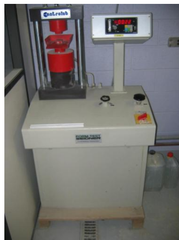
Figure I-15 : Mesure de la résistance à la compression sur demi-prismes
