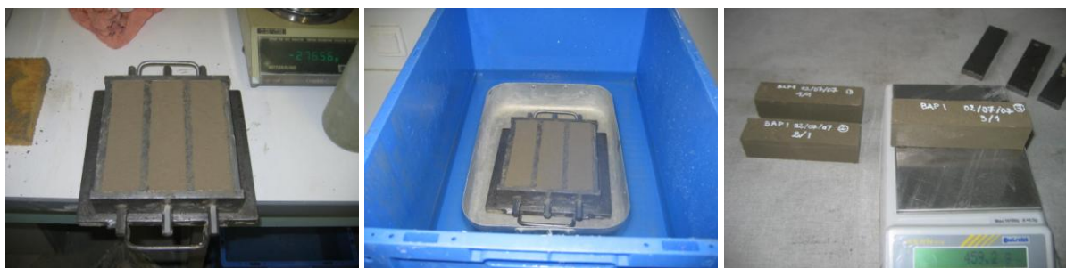
Figure III-7 : Confection des éprouvettes prismatiques en mortier autoplaçant
