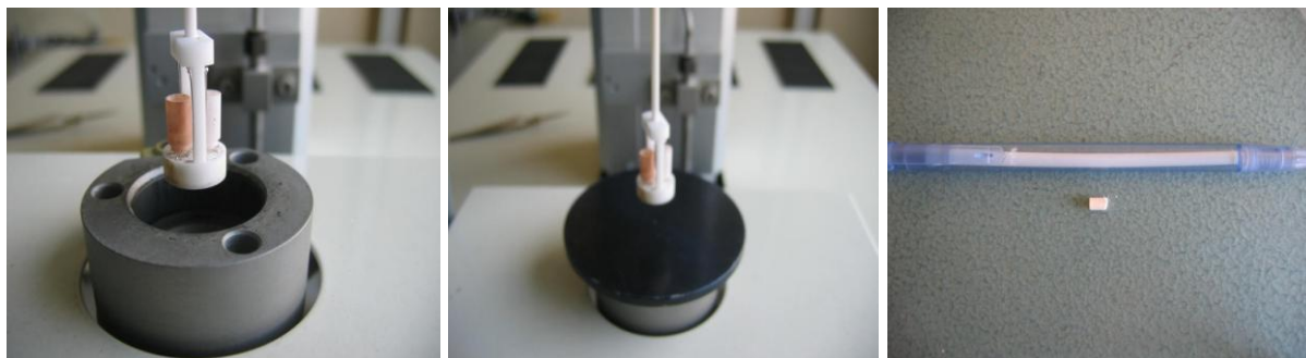
Figure IV-14 : Echantillon analysé à la thermogravimétrie
