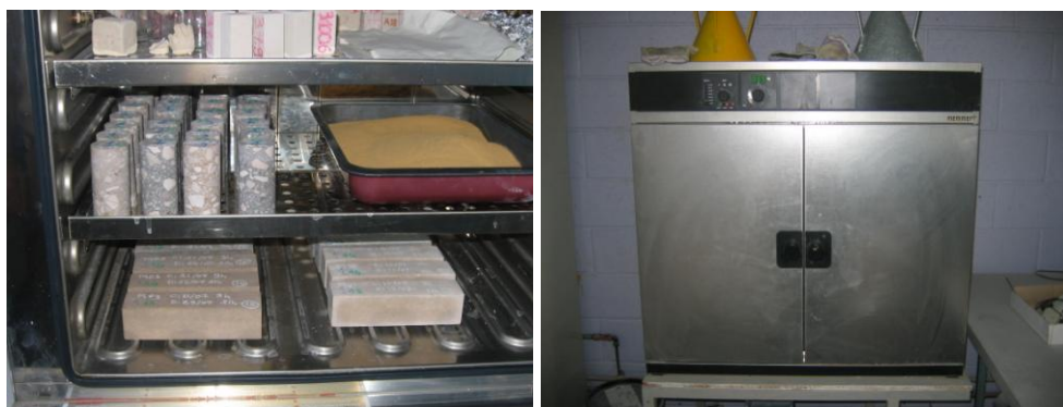
Figure III-13 : Etuves servant au séchage des éprouvettes à 60 et à 105°C
