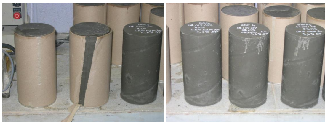
Figure III-6 : Confection des éprouvettes cylindriques en béton autoplaçant
