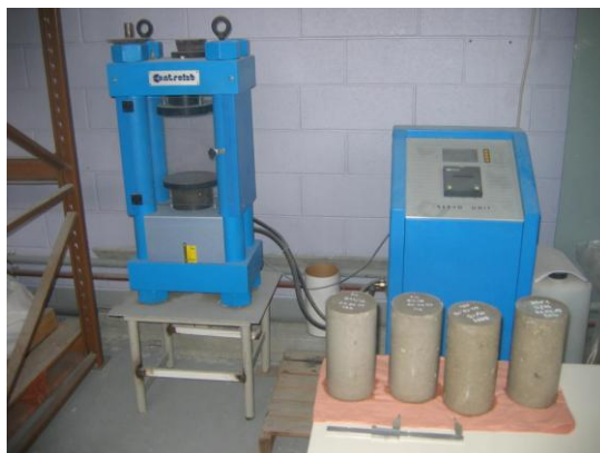
Figure I-13 : Mesure de la résistance à la compression des 11x22 cm
