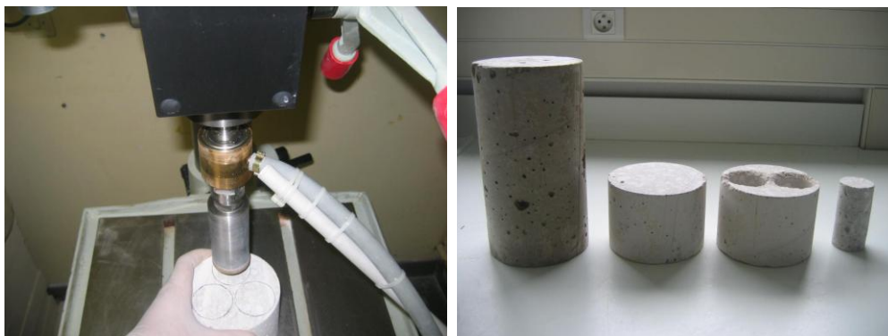
Figure III-11 : Confection des mini-cylindres en béton
