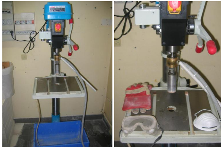
Figure III-10 : Carotteuse du laboratoire du CRMD d'Orléans
