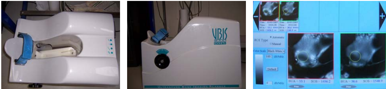
Figure 30: L'appareil à ultrasons UBIS 3000 permettant l'analyse du calcaneum et ainsi la détermination des valeurs de BUA (MHz) et de SOS (m/s-2).
