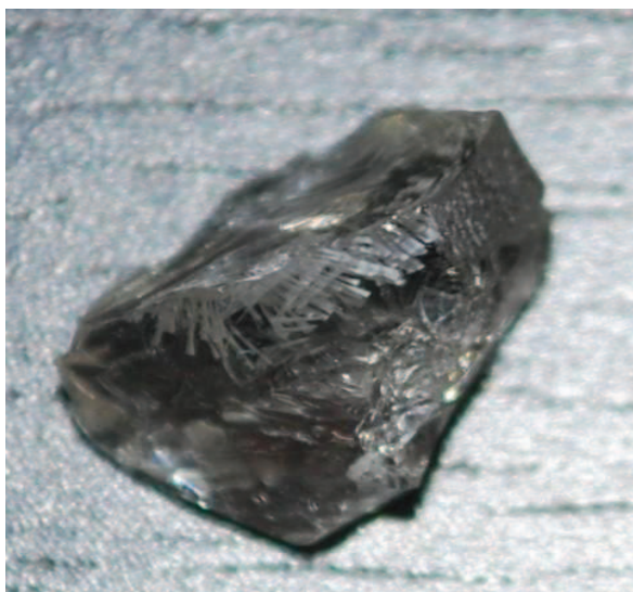
Figure IV.6. Photographie des verres II-L 0 Y 25 C 5 AS faisant apparaître des zones cristallisées
