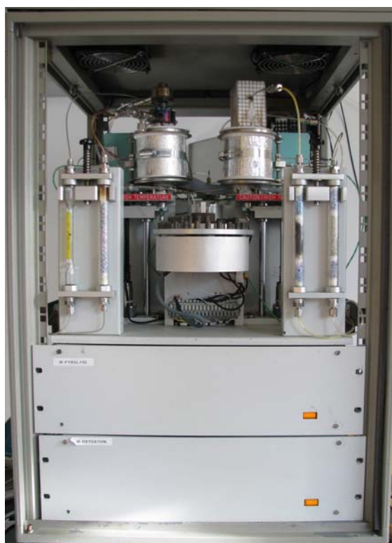
Figure 3.1. Vue d'ensemble du Rock-Eval 6 Turbo (a) et schéma de son circuit d'analyse (b) (d'après Behar et al. , 2001).
