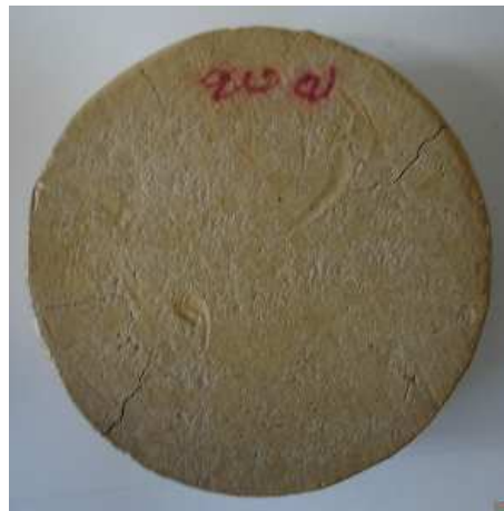
Echantillon traité avec 20% chaux
