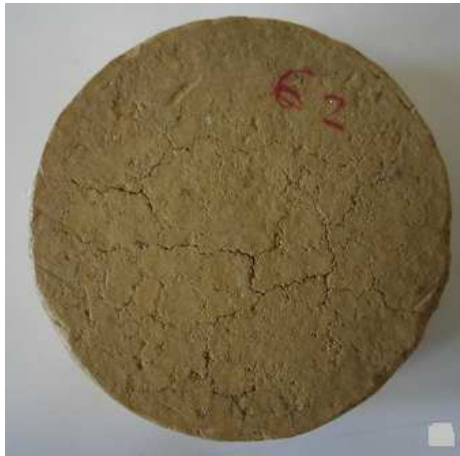
Echantillon traité avec 6% chaux
