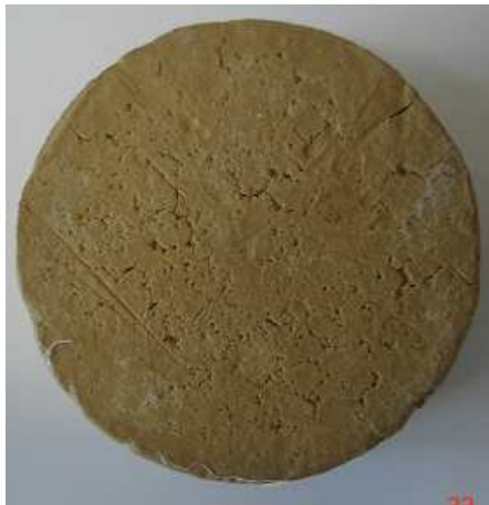
Echantillon traité avec 2% chaux
