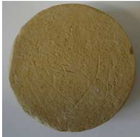
Echantillon traité avec 8% chaux
