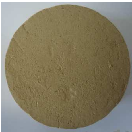
Echantillon traité avec 10% chaux
