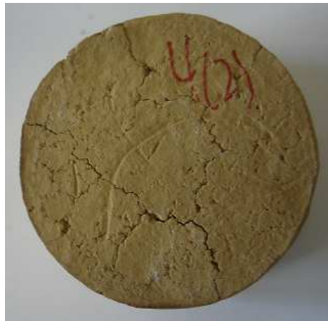
Echantillon traité avec 4% chaux
