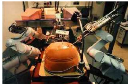
Figure 3.12. Schéma et photo du robot de chirurgie-mini-invasive Artemis.
