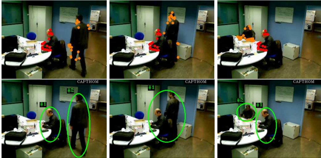
FIGURE 3.8: Illustration d'un résultat de suivi avec une occultation partielle temporaire. La première ligne correspond aux points d'intérêt suivis (une couleur par objet) et la deuxième ligne correspond au résultat du suivi avec l'identifiant de chaque objet suivi affiché.
