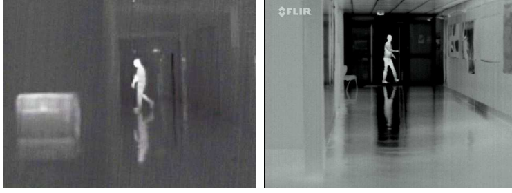
FIGURE 4.3: Exemples de réflexions sur des sols plastiques dans des images acquises par une caméra thermique.
