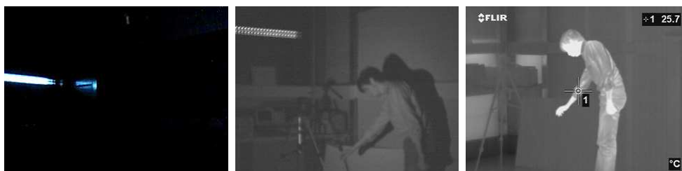
FIGURE 3.2: Exemple d'images obtenues en vision nocturne avec une caméra dans le spectre visible, le proche infrarouge (avec éclairage) et l'infrarouge.
