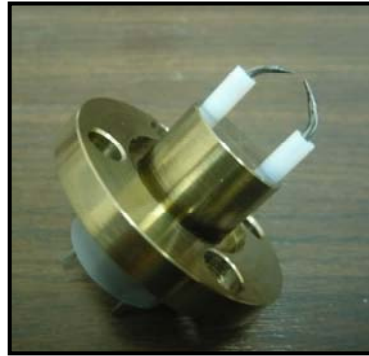
Figure 65. Electrodes isolées par du Teflon
