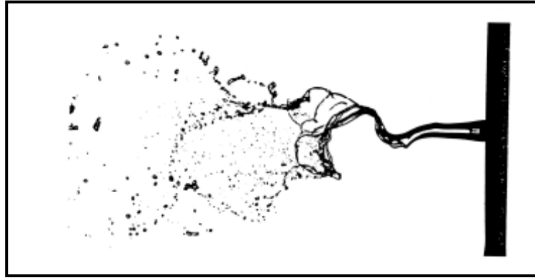
Figure 10. Jet liquide avec 25 < We_g < 70
