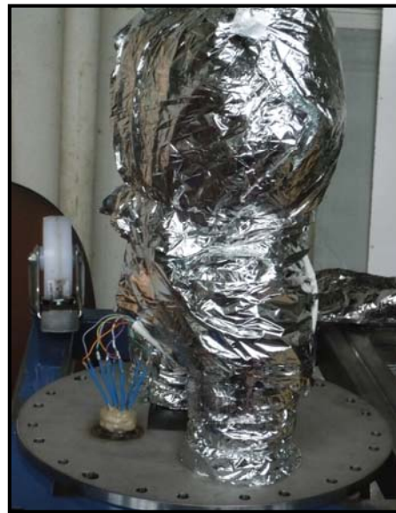
Figure 30. a. Cuve contenant le débitmètre Coriolis – b. Débitmètre Coriolis avec le super isolant, avant introduction dans la cuve
