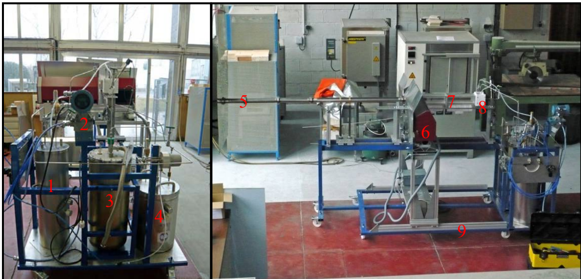
Figure 53. Dispositif d'étude granulométrique. -1. Echangeur de chaleur pour H2. -2. Afficheur du débitmètre Coriolis (LO2). -3. Cuve contenant le débitmètre Coriolis. -4. Echangeur de chaleur pour LO2. -5. Evacuation du LO2. -6. Granulomètre laser et plaques en aluminium. -7. Tube en quartz. -8. Dispositif d'injection. -9. Bâti
