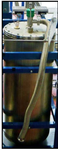
Figure 30. a. Cuve contenant le débitmètre Coriolis – b. Débitmètre Coriolis avec le super isolant, avant introduction dans la cuve
