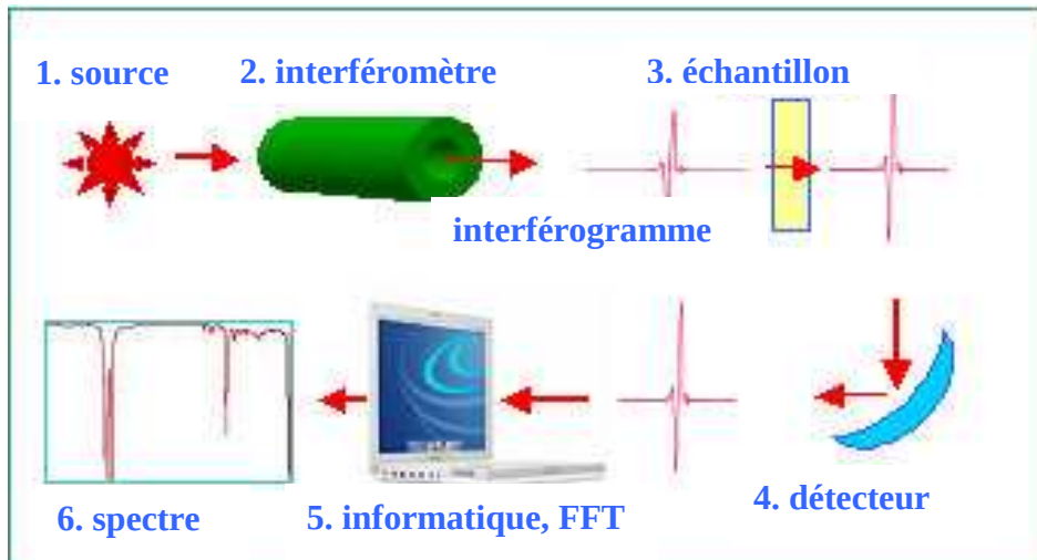
Figure 34 : schéma général du principe de fonctionnement d'un spectromètre IRTF
