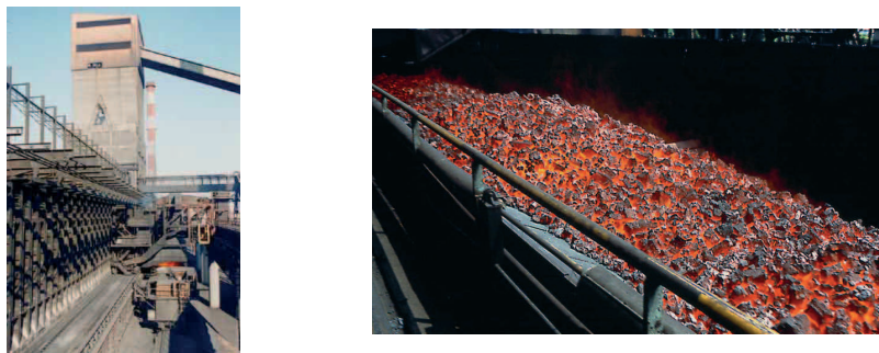
FIGURE 1.4 – Défournement et coke défourné.
