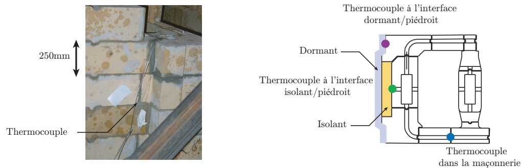
FIGURE 3.36 – Position des thermocouples en tête de piédroit.
