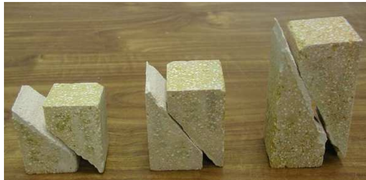
FIGURE 3.16 – Mode de rupture des échantillons avec joint de mortier incliné.
