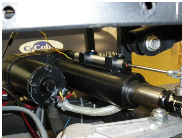
Figure 88- Vérin de direction équipé d'un potentiomètre linéaire
