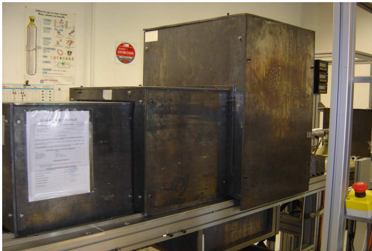
Figure 13 : Image de la protection en plomb de 10 mm d'épaisseur recouvrant la source.
