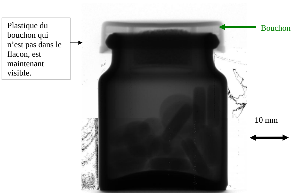
Figure 74 : Radiographie positive par caméra à sténopé d'un flacon de cachets pendant 2 secondes, avec la feuille de tungstène comme cible, à 400W.
