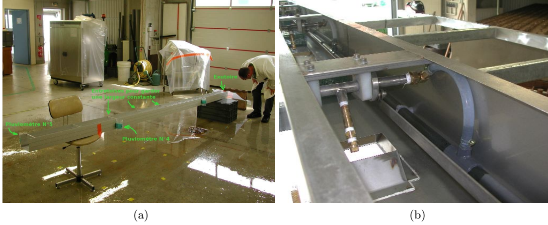
FIG. 6.1: Dispositif expérimental. (a) Le canal et (b) Les gicleurs (photos de l'unité Science du sol de l'INRA d'Orléans).
