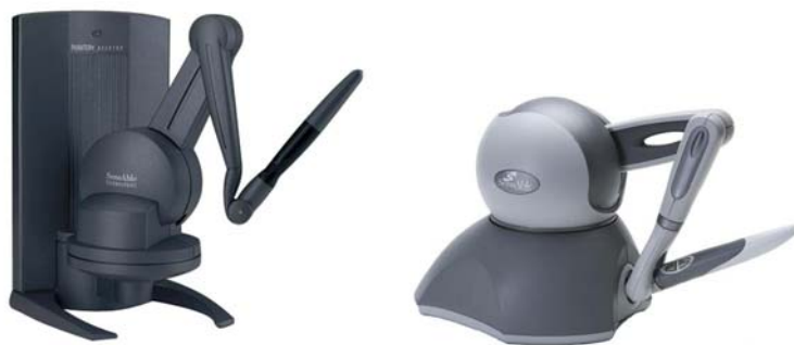
Figure 6.1 – Interfaces haptiques : Phantom Desktop et Phantom Omni de SensAble technologies.
