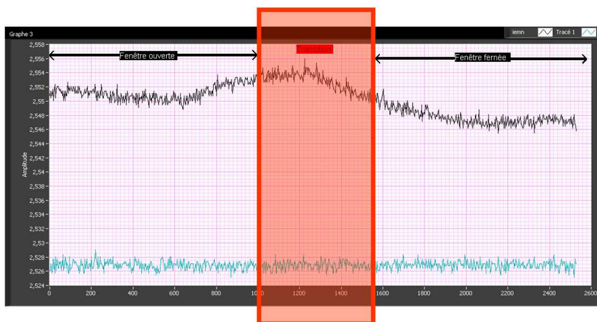
FIGURE 2.44 – représentation de la réponse en tension pour les deux capteurs (en noir, l'iemn et en bleu le Perkin Elmer) dans deux conditions différentes
