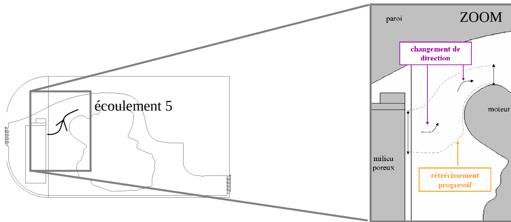
Figure V-21 : Décomposition, en pertes de charge élémentaires, de l'écoulement 5 en aval de la partie haute du milieu poreux.
