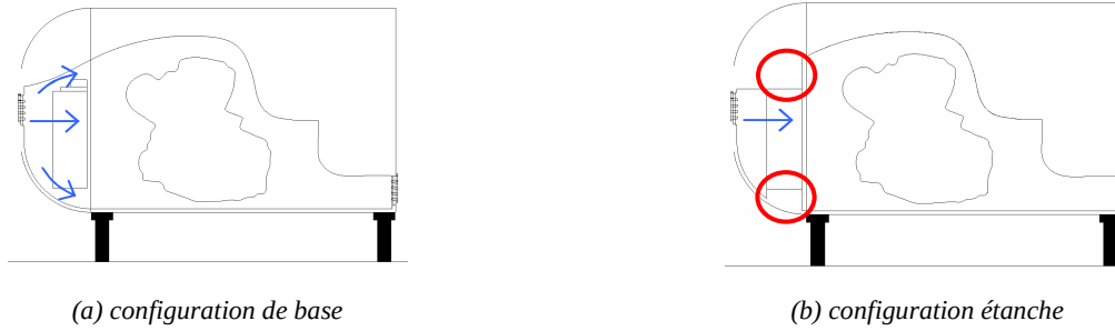
Figure IV-3 : Circuits d'air du compartiment moteur testés par simulation numérique.
