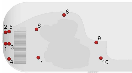
Figure III-8 : Position des prises de pression statique dans le circuit d'air du compartiment moteur.
