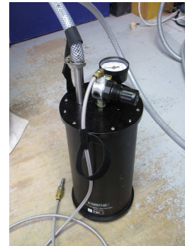
Figure A-6 : Pulvérisateur de type Laskin-Nozzle (a) et système utilisé lors des essais en soufflerie (b).
