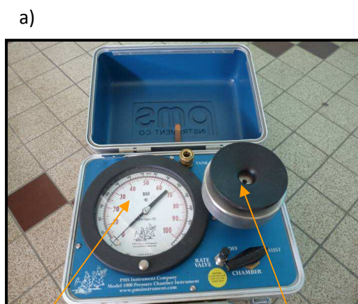
Manomètre indiquant la montée en pression (bar)
