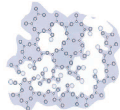
Figure I.6 : Représentation de la structure des verres selon le modèle de Réseau Modifié Aléatoirement (MRN) [9] : les grands cercles sombres représentent les atomes d'oxygènes, les petits les atomes formateurs et les grands cercles clairs les cations modificateurs.
