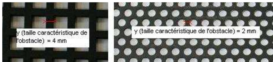
Figure 3.29 : Détermination de la taille caractéristique des obstacles ( y ) pour les grilles de type G4 et G5.
