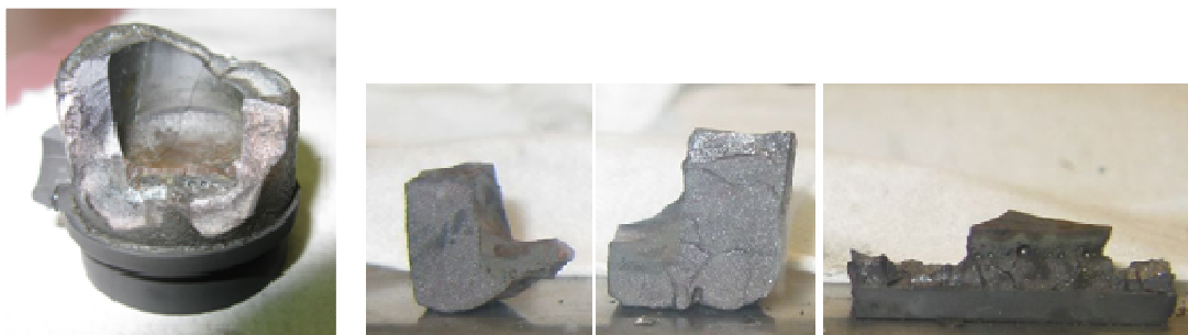
Figure 6-42 : Le mélange 30% \text{UO}_2 – 33% \text{Al}_2\text{O}_3 – 37% \text{Eu}_2\text{O}_3 en proportions massiques après le chauffage jusqu'à 1870^\circ\text{C} et le refroidissement dans un creuset en \text{UO}_2 . Le diamètre externe du creuset est de 27 mm.
