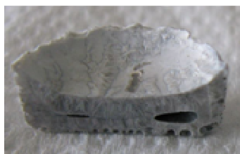
Figure 6-39 : Le mélange 50% \text{HfO}_2 + 50% \text{Al}_2\text{O}_3 en proportions massiques après le chauffage jusqu'à 2120^\circ\text{C} et le refroidissement dans un creuset en tungstène. Le diamètre externe de la charge est de 20 mm.
