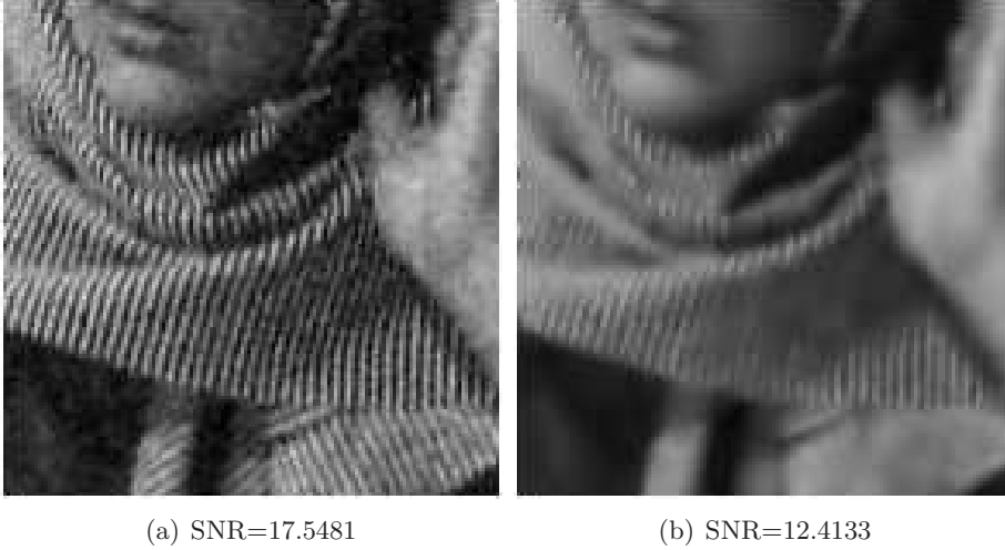
FIG. V.3 – (a) est l'image bruitée par un bruit blanc gaussien ( \sigma = 25 ). (b) est l'image ayant subi un débruitage par le modèle mixte ( \lambda = 30 , \mu = 20 ). Le SNR de (a) est plus élevé même si l'image (b) ne contient plus de bruit. Ceci vient du fait qu'une grande partie de la texture de (b) a également disparue.
