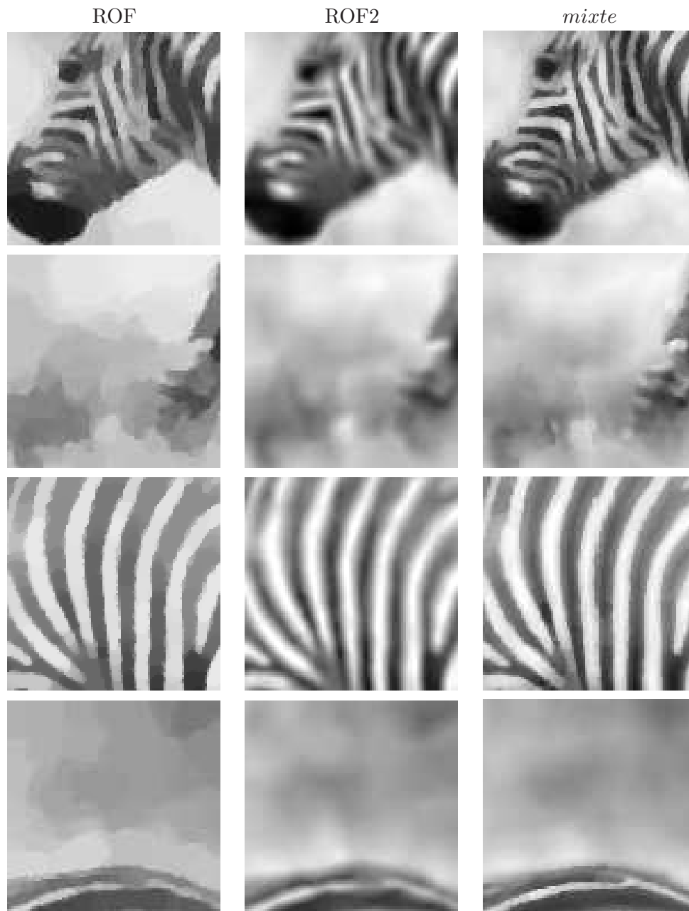
FIG. V.31 – L’augmentation de l’intensité du bruit permet de mettre en valeur les différences des trois modèles. Le modèle mixte est clairement flou sur les zones homogènes comme le modèle ROF2 mais possède beaucoup plus d’information au niveau des détails, où un léger effet de staircasing semble apparaître.
