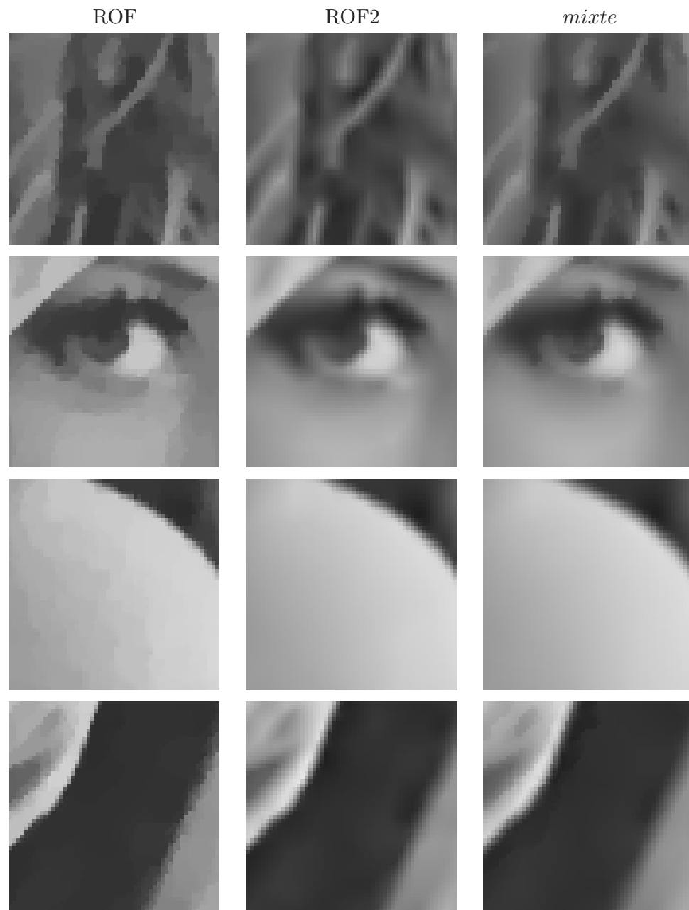
FIG. V.29 – Encore une fois, nous remarquons que le modèle mixte semble se comporter comme le modèle ROF là où il y a des détails (plumes du chapeau, oeil) et comme le modèle ROF2 ailleurs.
