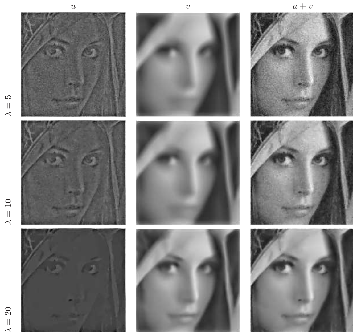
FIG. V.16 – Influence de \lambda (B-1). \sigma = 20 et \mu = 30 . Les observations sont identiques à celles de la figure V.13 : la composante u perd de plus en plus d'information au fur et à mesure que \lambda augmente, d'abord le bruit, puis de plus en plus de détail. On observe pour \lambda = 20 que l'image restaurée u + v ne possède plus de bruit alors que les détails (visage et plumes du chapeau) sont très bien conservés.
