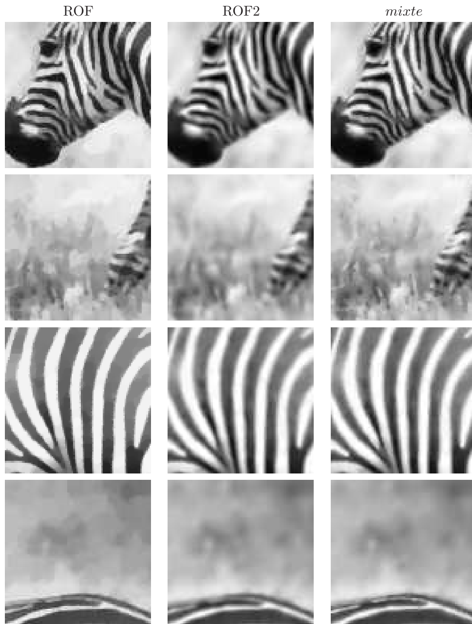
FIG. V.27 – Les effets staircasing du modèle ROF ainsi que l'effet de flou engendré par le modèle ROF2 sont bien visibles. Il est intéressant de remarquer que le modèle mixte semble se comporter comme le modèle ROF sur les zones possédant des détails (tête, herbe autour de la patte), et comme le modèle ROF2 ailleurs.
