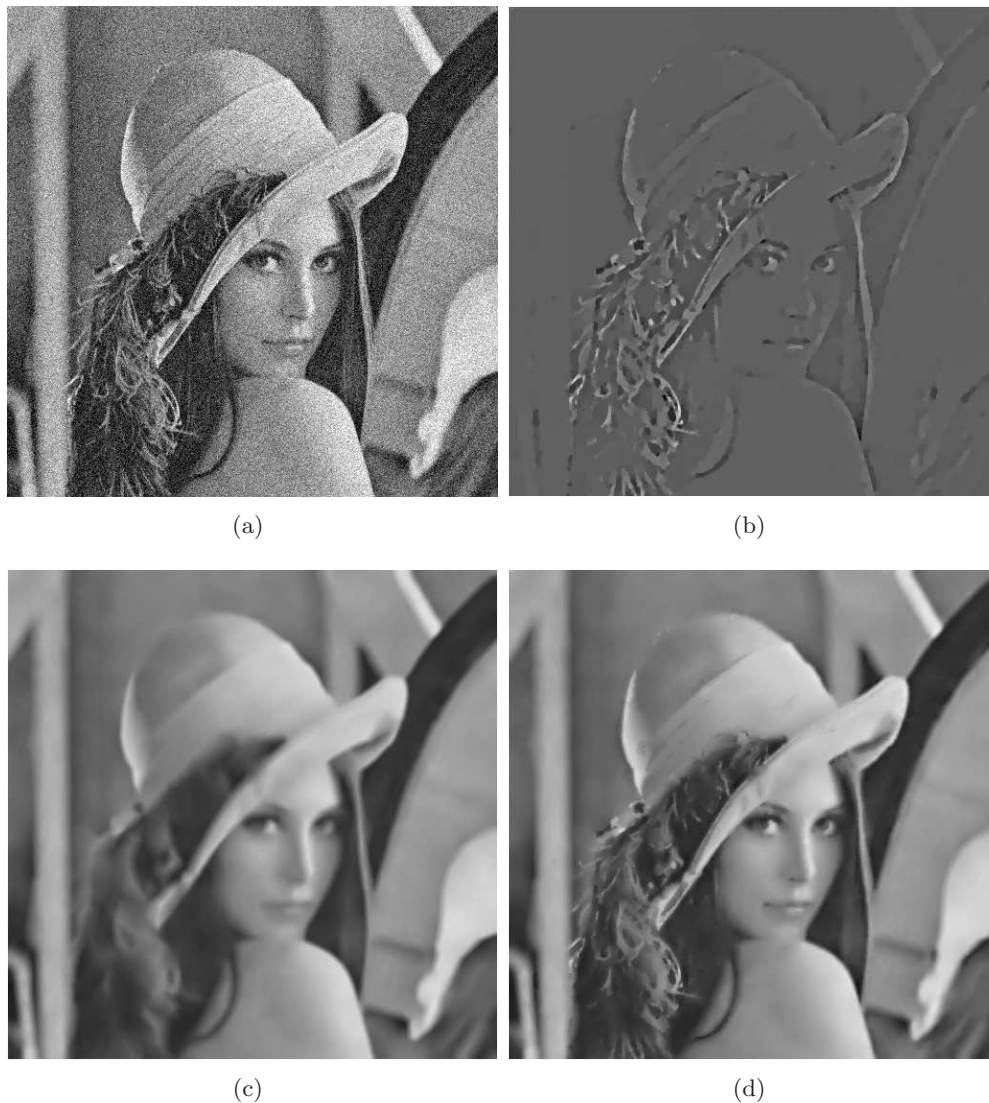
FIG. II.5 – Utilisation du modèle mixte pour la restauration d'image. (a) image bruitée par un bruit blanc Gaussien ( \sigma = 25 ); (b) composante u de l'a solution; (c) composante u de la solution; (d) image restaurée ( u + v ). On observe que u contient l'information géométrique de l'image et que v est très lissée. La somme des deux nous permet d'obtenir une image restaurée sans effet staircasing préservant de façon convenable l'information géométrique de l'image de départ.
