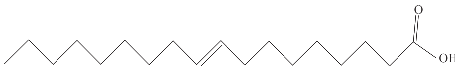
Figure 2.8: Molécule d'acide oléique C_{18}H_{34}O_2 .
