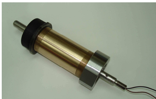
Rys. 2.2. Widok obiektów badań: (a) amortyzator LORD RD 1005-3; (b) tłumik T-MR SiMR 132 DG
