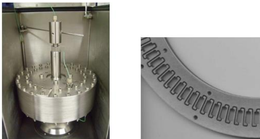
Figure III-1: Photographie d'une colonne de 200 mL d'un appareil FastCPC (FCPC, Kromaton, Angers) et détail d'un des disques constitutifs de la colonne [14].
