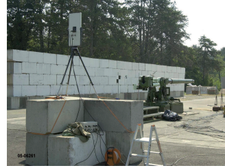
(c) Utilisation du radar pendant un tir
