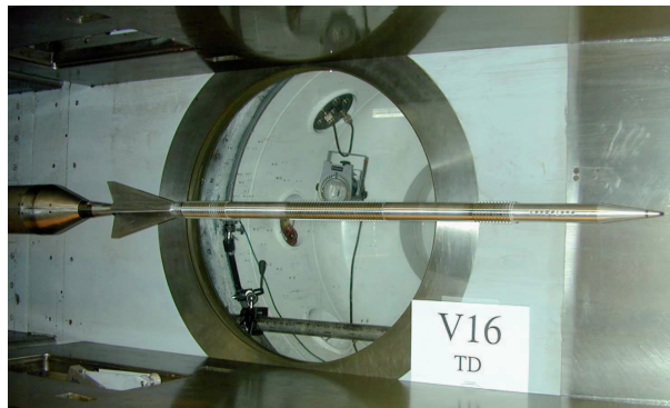
FIGURE 1.1 – Maquette d'un projectile dans une veine d'écoulement
