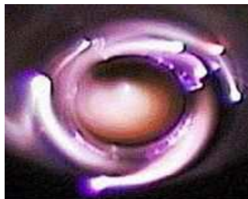
Figure 1.11 . Photographie de la décharge glissante tournante dans l'air.
