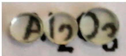
Figure IV. 4. Céramique de \text{SrAl}_2\text{O}_4 polie et complètement cristallisée obtenue directement après la trempe d'un mélange (\text{SrO})_{50} (\text{Al}_2\text{O}_3)_{50}
