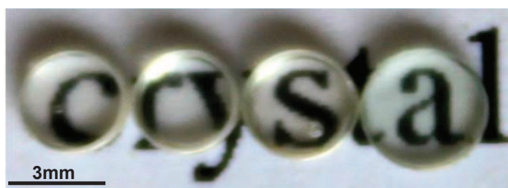
Figure IV. 24 Matériaux cristallins de \text{SrAl}_2\text{O}_4 élaborés par lévitation aérodynamique (polis après élaboration)
