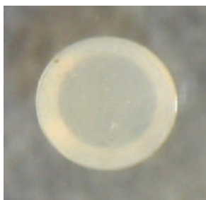
Figure IV. 21 Céramique de \text{BaAl}_4\text{O}_7 (II) contenant 28% massique de \text{BaAl}_2\text{O}_4 , élaborée à partir du verre de (\text{BaO})_{37}(\text{Al}_2\text{O}_3)_{63}
