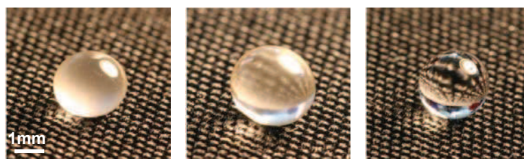
Figure III. 1 De gauche à droite: billes de YAG-0Si, YAG-2Si et YAG-4Si préparées par lévitation aérodynamique
