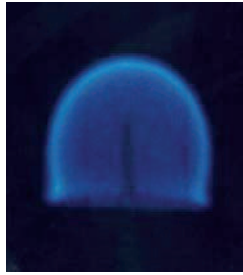
Figure 13 : Flamme de bougie en microgravité.
