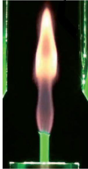
Figure 7: Photo de flamme avec ensemencement de l'écoulement d'air coaxial ( Q_{CH_4}=15 \times 10^{-6} \text{ m}^3/\text{s} et Q_{air}=23,7 \times 10^{-6} \text{ m}^3/\text{s} ).
