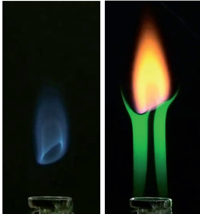
Figure 4 : Comparaison de la flamme dans des conditions d'injection identiques sans et avec encens.
