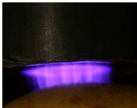
Figure 32 : Photo d'une décharge à barrière diélectrique (FE-DBD) dans l'air
