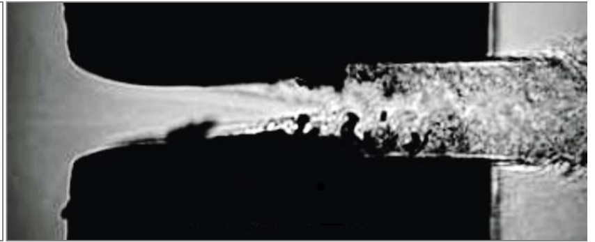
FIG. 1.2 : Visualisation en image de transmission d'un écoulement cavitant – h = 400 \mu\text{m} – L = 2 \text{ mm} – P_i = 5 \text{ MPa} – P_b = 1,5 \text{ MPa} [Mauger et al. , 2011]
