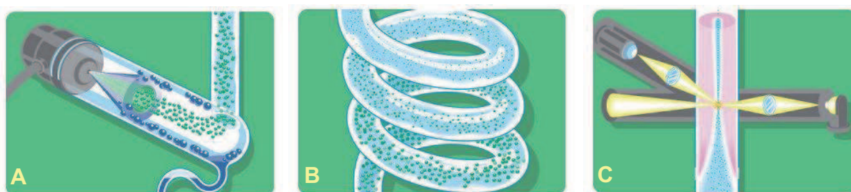
Figure II.20. Fonctionnement d'un détecteur évaporatif à diffusion de la lumière [86]
