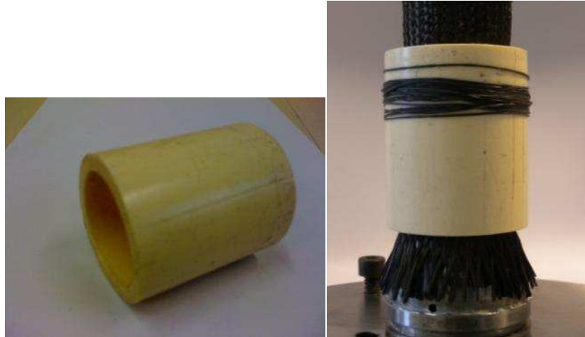
Figure 149 : Gabarit de distance entre ligatures
