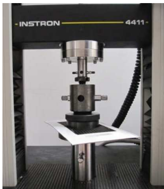
Figure 45 : Empilement entre poinçons - Essai de compaction
