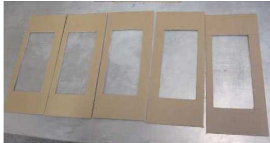
Figure 47 : Gabarits pour garantir un état de cisaillement nul
