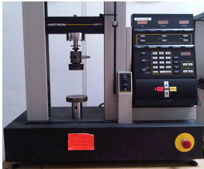
Figure 44 : Dispositif de compaction
