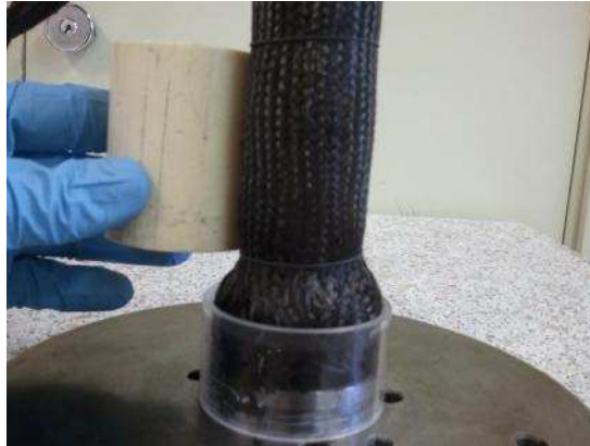
Figure 161 : Bague et gabarit en cours de préformage
