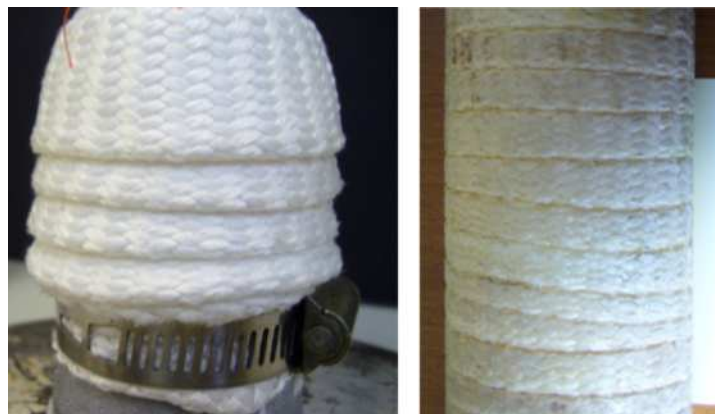
Figure 125 : Préforme de silice ( e_{\text{tresse}} = 0,8 \text{ mm} ) (Gauche : sèche - Droite : injectée)
