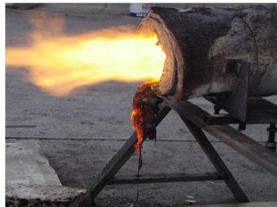
Figure IV-108 Réacteur de TKEnergy- zone haute température
