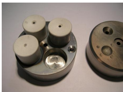
Figure III-13 Creusets utilisé en nitrure de bore- 2 échantillons et la référence en silice pure
