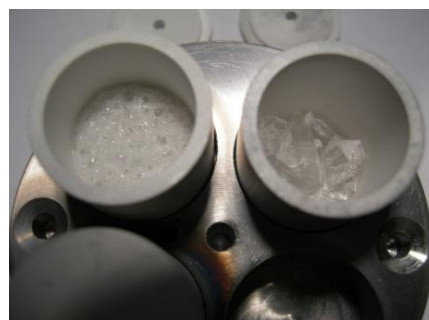
Figure III-14 75% m SiO_2 -25% m P_2O_5 (à gauche) 50% m SiO_2 -50% m P_2O_5 (à droite) après essai
