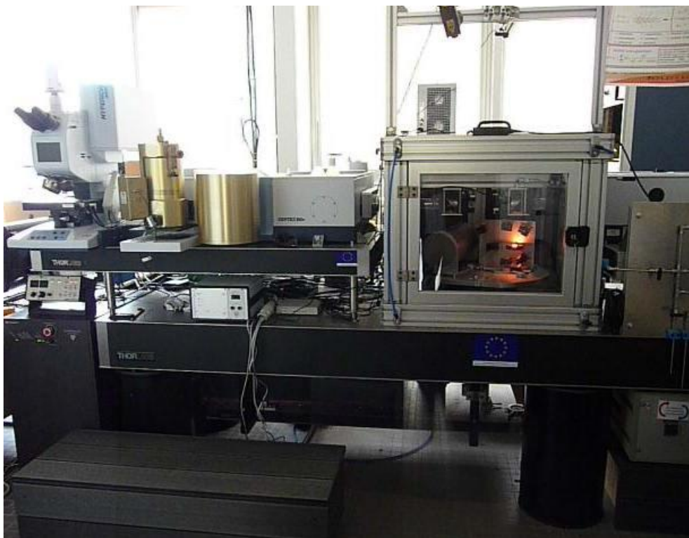
Figure 12 : Dispositif d'émission infrarouge incluant les spectromètres infrarouges Vertex 70 et 80v.
