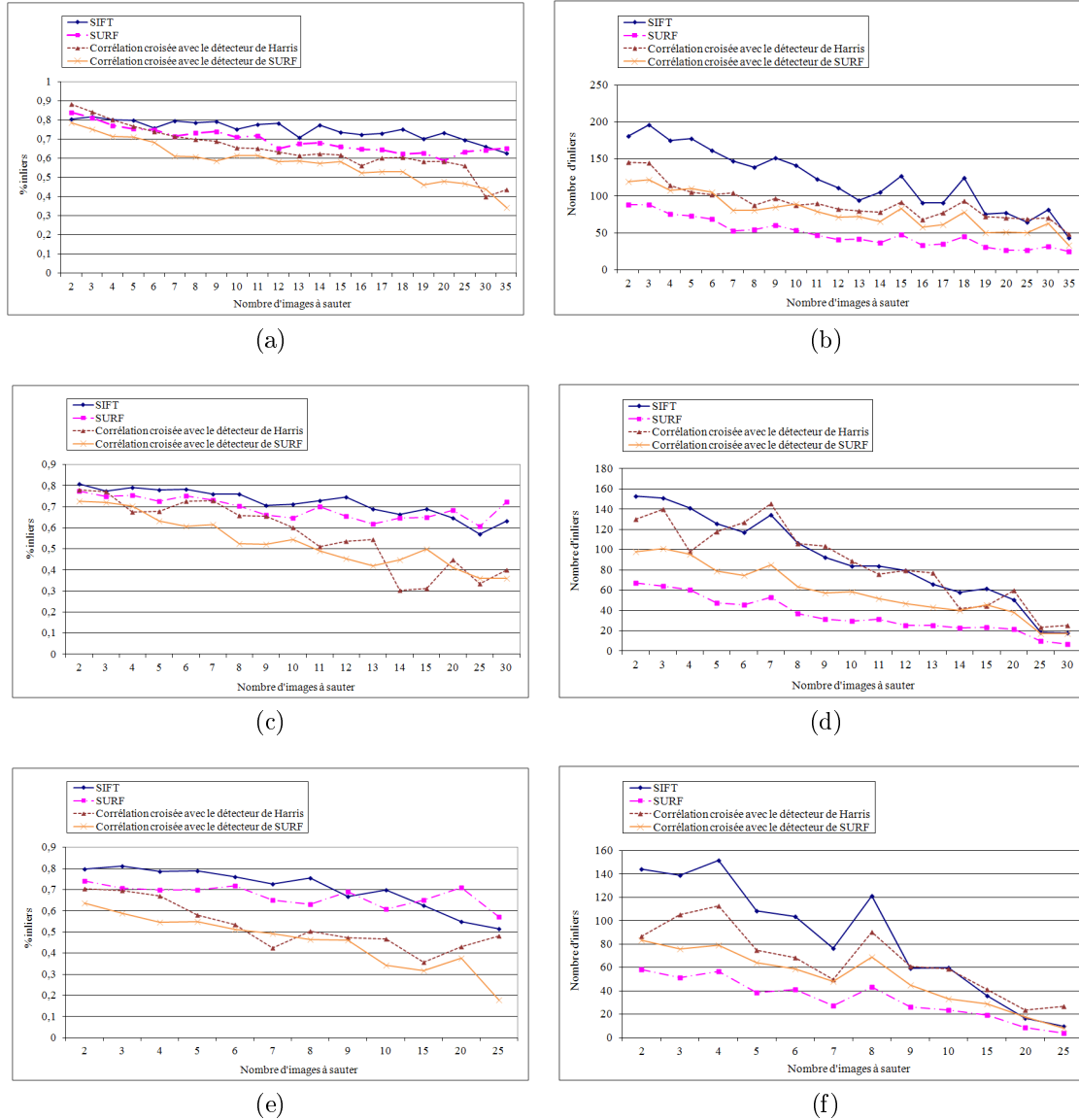
FIGURE 2.10: Evaluation des descripteurs à une transforamtion de changement d'échelle : (a), (b) représentent respectivement la variation du pourcentage moyen des inliers et la variation du nombre moyen des inliers en fonction de la distance parcourue pour la séquence Translation _v25, (c), (d) correspondent à la séquence Translation _v50 et (e), (f) correspondent à la séquence Translation _v100.
