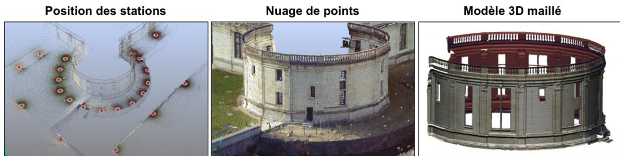
FIGURE 107 : MODELE 3D DE LA TOUR DU CHAUDRON REALISE PAR LASERGRAMMETRIE
