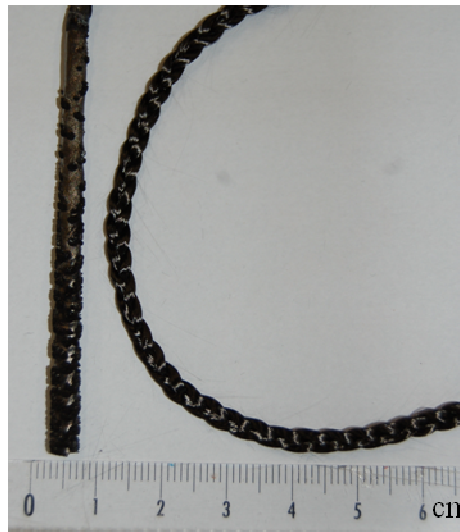
Figure II. 3 : Photographie d'une tresse de fibre de carbone avant la caléfaction (à droite) et après la caléfaction (à gauche)
