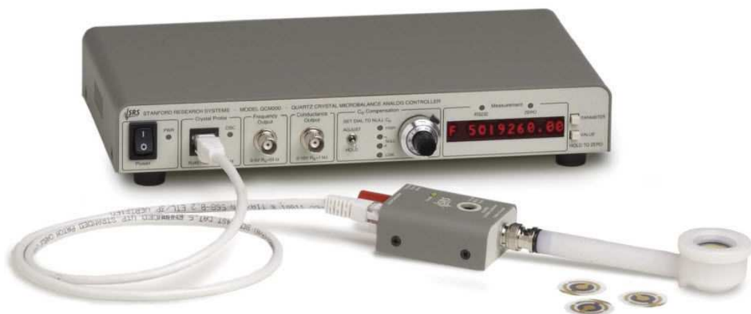
Photographie de la microbalance à cristal de quartz, des lames de quartz et de son générateur [2].
