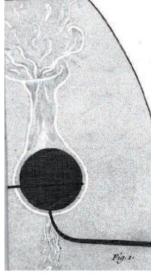
FIGURE 11.1 – Ombrogramme issu de l'ouvrage de Marat [10]. Il représente un boulet en acier chauffé soumis à la convection naturelle.
