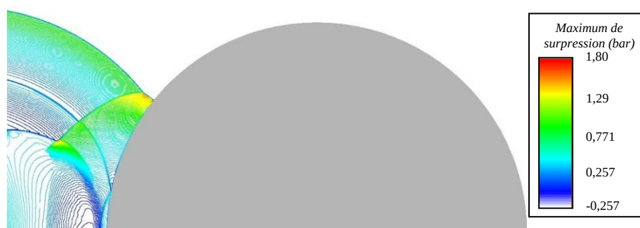
Figure A10 : Visualisation de la propagation d'une onde de choc sur une surface convexe ( R = 0,18 \text{ m} , soit 1,10 \text{ m/MJ}^{1/3} ) pour un obstacle placé à d = 0,12 \text{ m} (soit 0,73 \text{ m/MJ}^{1/3} ) du centre d'une charge de gaz (propane-oxygène à la stœchiométrie, E = 4,4 \cdot 10^{-3} \text{ MJ} ) ( t = 0,28 \text{ ms} , soit 1,71 \text{ ms/MJ}^{1/3} )
