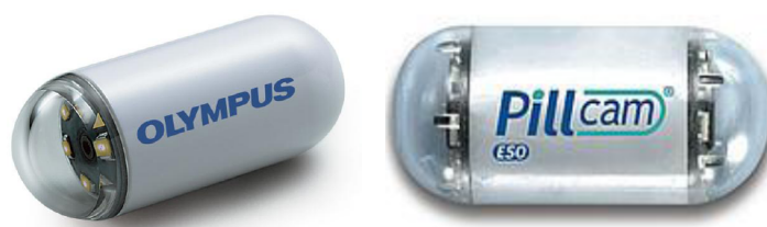
Figure I.4 – Capsules endoscopiques : (à gauche) celle développée par la société Olympus et (à droite) la PillCam® ESO proposée par la société Given Imaging.
