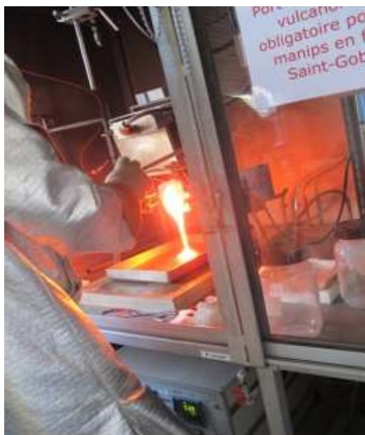
Figure 141. Photo d'une coulée sur plaque à 1300°C après élaboration en four Saint Gobain par basculement du creuset.
