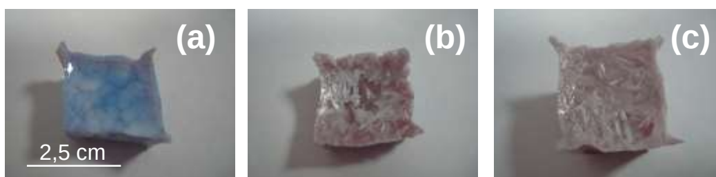
Figure 58. Observations macroscopiques des échantillons (a) B14Nd10 RLT-10, (b) B14Nd10 RLT-1 et (c) B14Nd10 RLT-0,5 ayant subi une descente en température de 10°C/min, 6°C/min, 1°C/min, et 0,5 °C/min respectivement.
