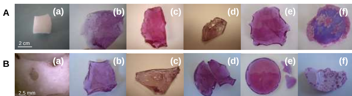
Figure 49. Observations macroscopiques des verres au néodyme refroidis à 1°C/min depuis l'état fondu à 1350°C des séries (A) B14Ndx et (B) B20Ndx pour des teneurs en néodyme de (a) 0 (b) 2,3 (c) 4 (d) 6 (e) 8 et (f) 10 % molaires.
