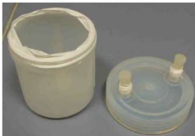
Figure 159. Photo des réacteurs savillex® utilisés pour les tests en mode statique.
