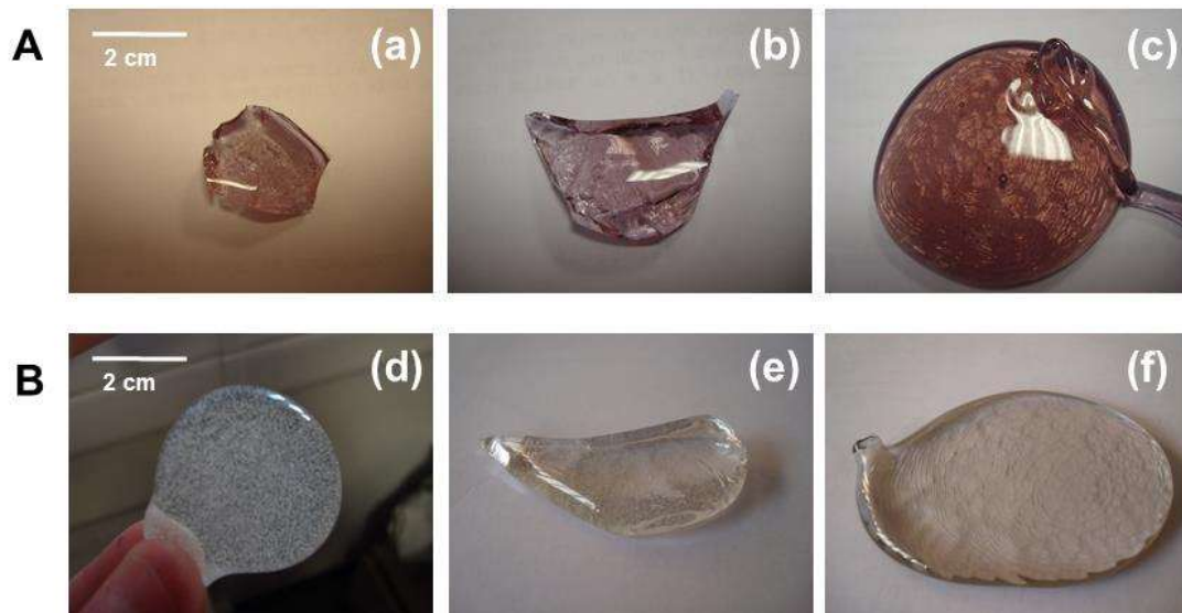
Figure 35. Observations macroscopiques des verres des séries (A) BxNd_4 et (B) BxLa_4 : (a) B8Nd_4 (b) B14Nd_4 (c) B20Nd_4 (d) B8La_4 (e) B14La_4 et (f) B20La_4 .
