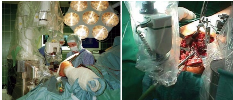
Figure 1.4 – Robot d'orthopédie Robodoc. A gauche : le robot est utilisé pour la chirurgie de remplacement total de la hanche. A droite : gros-plan sur le fraisage robotisé du fémur. [Kazanzides et al. , 2008]
