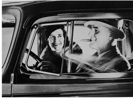
FIGURE 1.1 – Système No-draft ventilation proposé par Fisher Body en 1933 et utilisé sur les modèles GM. (d'après GM)
