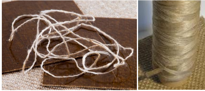
Figure 1-1: Renfort sous forme de fil (gauche) et mèche (droite).
