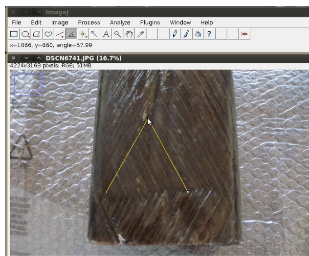
Figure 4-9: Mesure d'angle avec ImageJ
