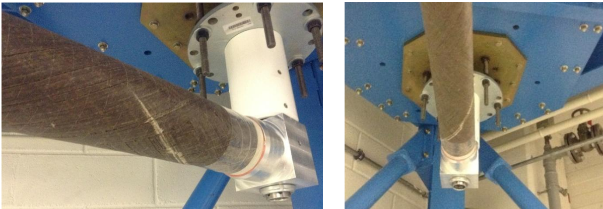
Figure 4-19: Localisation de la rupture en flexion.
