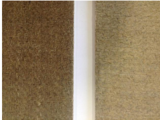
Figure 5-16: Décoloration suite à l'exposition à l'humidité.
