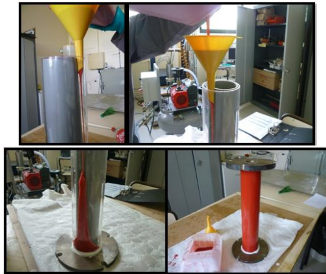
Figure 2-23: Moulage de la membrane en silicone
