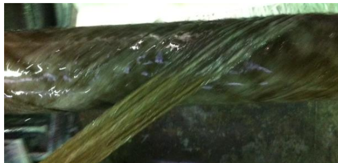
Figure 4-12: Enroulement par nappe de 8 mèches.
