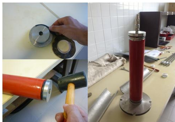
Figure 2-19: Mise en place des chapeaux
