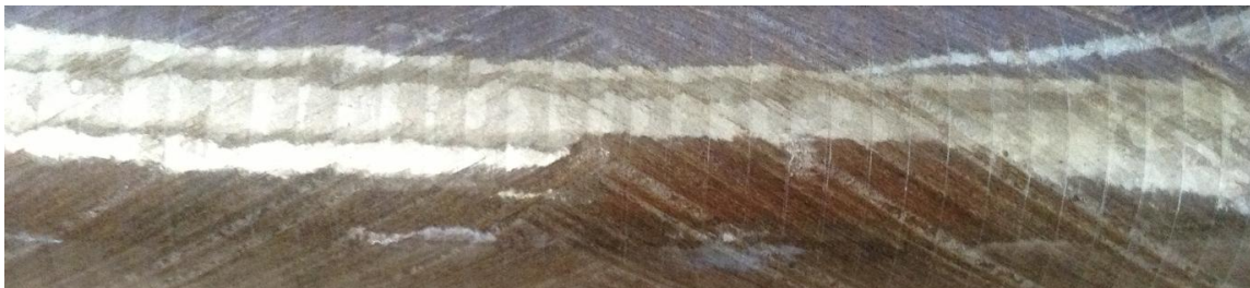
Figure 4-27: Finition au film thermo-rétractable.
