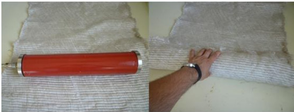
Figure 2-20: Mise en forme du renfort sur la membrane
