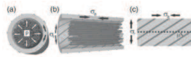
Figure 23. Modèle pour la génération d'une contrainte de traction dans une cellule de bois de tension. (a) La pression p générée par le gonflement de la couche G est converti en une contrainte de traction annulaire circonférentielle \sigma_r au sein de la paroi cellulaire. (b) Le stress circonférentiel est converti en stress de traction axial \sigma_a au sein de la paroi cellulaire. (c) Le ratio \sigma_a et \sigma_r (facteur de rehaussement de la contrainte, F ) est gouverné par la direction des fibrilles de cellulose rigides au sein de la paroi. L'angle des microfibrilles est schématiquement indiqué par des lignes inclinées dans la paroi cellulaire (Goswami et al. 2008).
