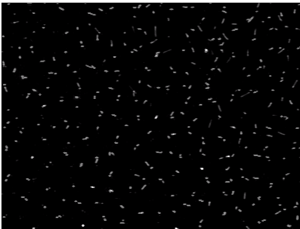
Рисунок 2.6 - Фотоизображение плазменно-пылевых структур, образованных в плазме высокочастотного разряда. Давление рабочего газа p=0.3 торр, мощность разряда P=10 Вт
