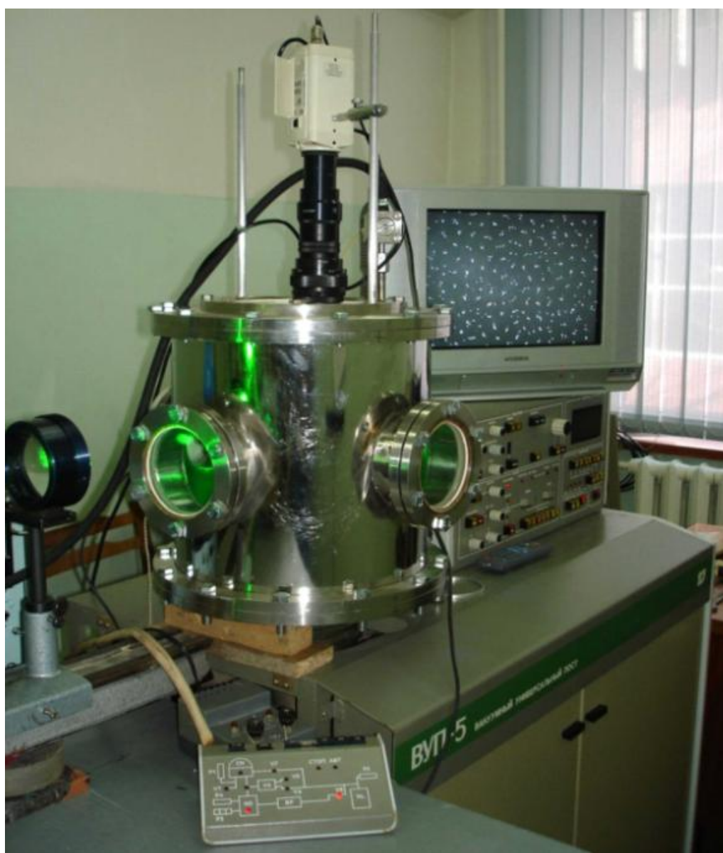
Рисунок 2.1 – Фотоизображение экспериментального стенда на основе высокочастотного емкостного разряда для генерации плазменно-пылевых структур
