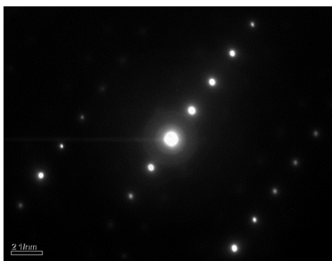
Figure II.10 : Cliché de diffraction d'un échantillon de tungstène Goodfellow irradié avec des ions Fe 10 MeV à la fluence 6.09 \times 10^{15} \text{ cm}^{-2} .
